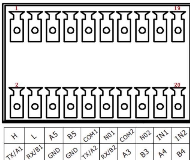
图 3-2-1 2x10Pin 串行数据接口图
